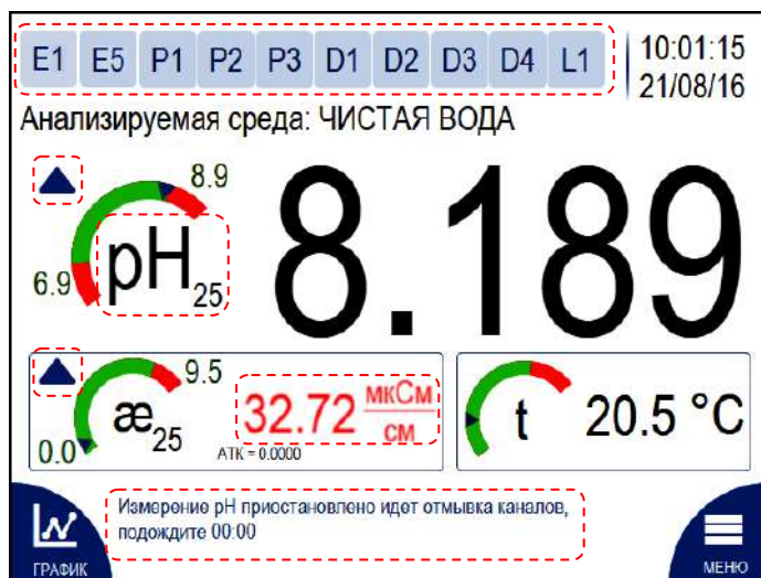
Рисунок 2.10 – Экран измерений с индикацией возможных неисправностей и предупреждений
